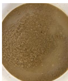
写真 2.2 重力濃縮汚泥の供試汚泥と1パス後の汚泥性状
