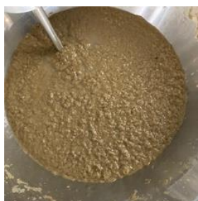
写真 2.2 重力濃縮汚泥の供試汚泥と1パス後の汚泥性状
