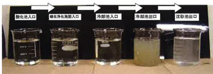
写真 4 冷却池の濁度の上昇
