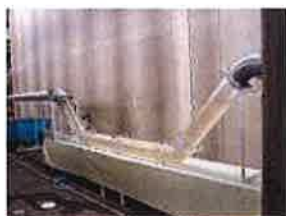
写真-1 本管ベンドサイフォン実験設備
