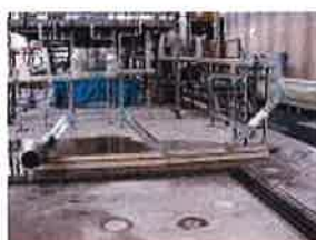
写真-2 取付管ベンドサイフォン実験設備
