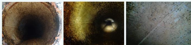
図-5 SGPWの腐食漏水状況
