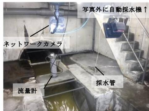
図3 自動採水器設置状況
